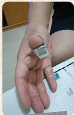
明叔：「由我學師開始，這針頂一直是我的好幫手。」針頂是手指頭在縫線時的「金鐘罩」，防止線針刺傷手指頭。
